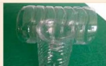
6 Placez le toit au-dessus de l'entonnoir afin d'éviter que votre piège devienne un « pluviomètre »
